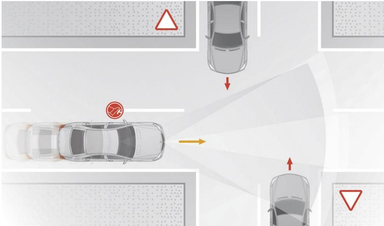
Die Funktion Kreuzungs-Assistent ist im Geschwindigkeitsbereich bis ca. 72 km/h wirksam, der BAS PLUS kann im Längsverkehr im gesamten Geschwindigkeitsbereich unterstützen.
