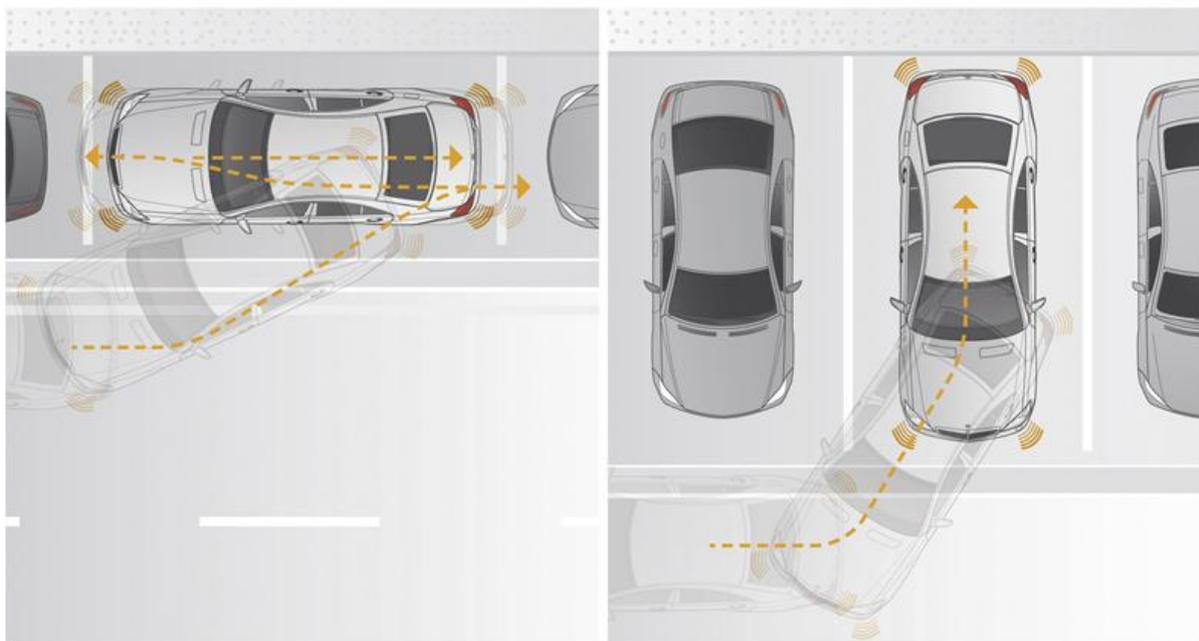
Der Aktive Park-Assistent ermöglicht automatisches Einparken mit aktiven Lenk- und Bremsengriffen in **Längs- und Querparklücken**. Er ist eine Weiterentwicklung des bisher angebotenen Systems PARKTRONIC mit Parkführung. Darüber hinaus kann das System das Fahrzeug aus Längsparklücken nun auch mit automatischen Lenk- und Bremsengriffen selbstständig ausparken, wenn es zuvor automatisch eingeparkt wurde.
