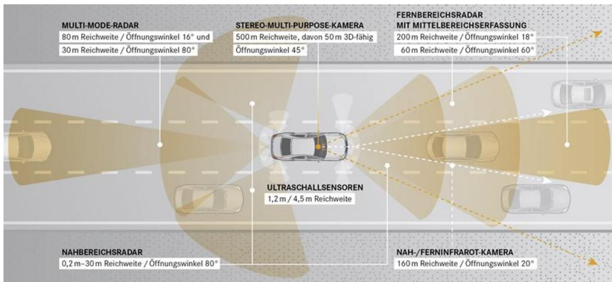
Weitere umfangreiche Sensorik kann den Fahrzustand sowie die Reaktionen des Fahrers erfassen. Erkennen die Sensoren gefährliche Situationen, können sie die Algorithmen unterschiedlichster Assistenzsysteme mit Daten versorgen und so für eine situationsgerechte Unterstützung sorgen.
