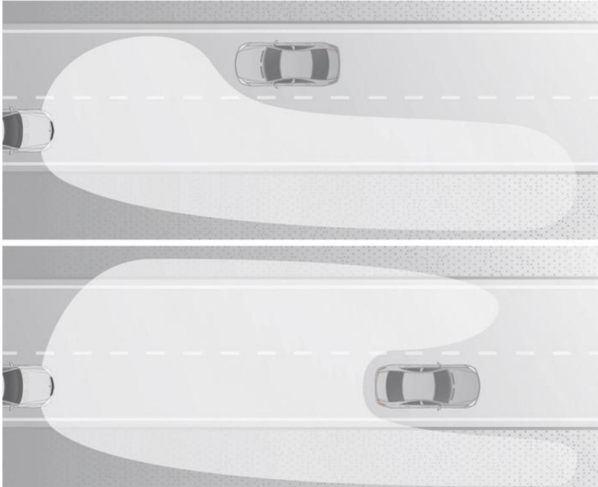
Mögliche Eigenblendungen durch die verstärkte Nutzung des Fernlichts und stark reflektierende Schilder am Straßenrand werden erkannt und durch gezieltes Dimmen der Scheinwerfer vermieden.
